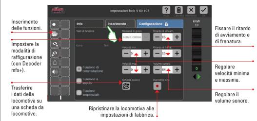
Importante: i dati modificati vengono immediatamente memorizzati nel Decoder della loco. Le locomotive MM e DCC per l'elaborazione devono trovarsi sul binario di programmazione.
