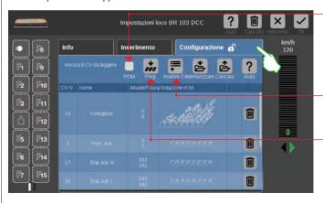
Con l'opzione POM (Programming on the Main) i Decoder DCC adatti a questo scopo sono programmabili anche sul binario principale.
