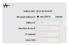
Questa opzione si trova a disposizione qualora Voi colleghiate la Vostra Central Station 3 al Vostro Router tramite un cavetto LAN. Qui avete la scelta se la CS3 deve procurarsi i necessari indirizzi della rete automaticamente dal Router oppure se inserite Voi tali dati a mano.
