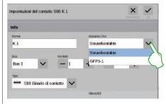
Nel menù a tendina "Apparecchio" impostate l'apparato al quale Voi avete collegato il contatto di retroazione. Nel caso della CS3 plus Voi trovate qui l'opzione "GFP3-1", che corrisponde alla connessione S88 sul lato inferiore (figura a sinistra). Con la CS3 (60226) i moduli di retroazione si devono collegare tramite il Link S88 (si veda sotto).
