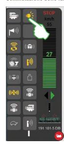
Tramite un tocco del simbolo di funzione le funzioni vengono commutate. Nella figura a sinistra sono attivati ad esempio i fanali, l'aggancio/sganciamento, il fischio ed il ventilatore.
