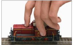
Preparativi: Collocare la locomotiva mfx completamente sul binario. La registrazione di locomotive mfx è possibile tanto sul binario principale quanto anche sul binario di programmazione.
