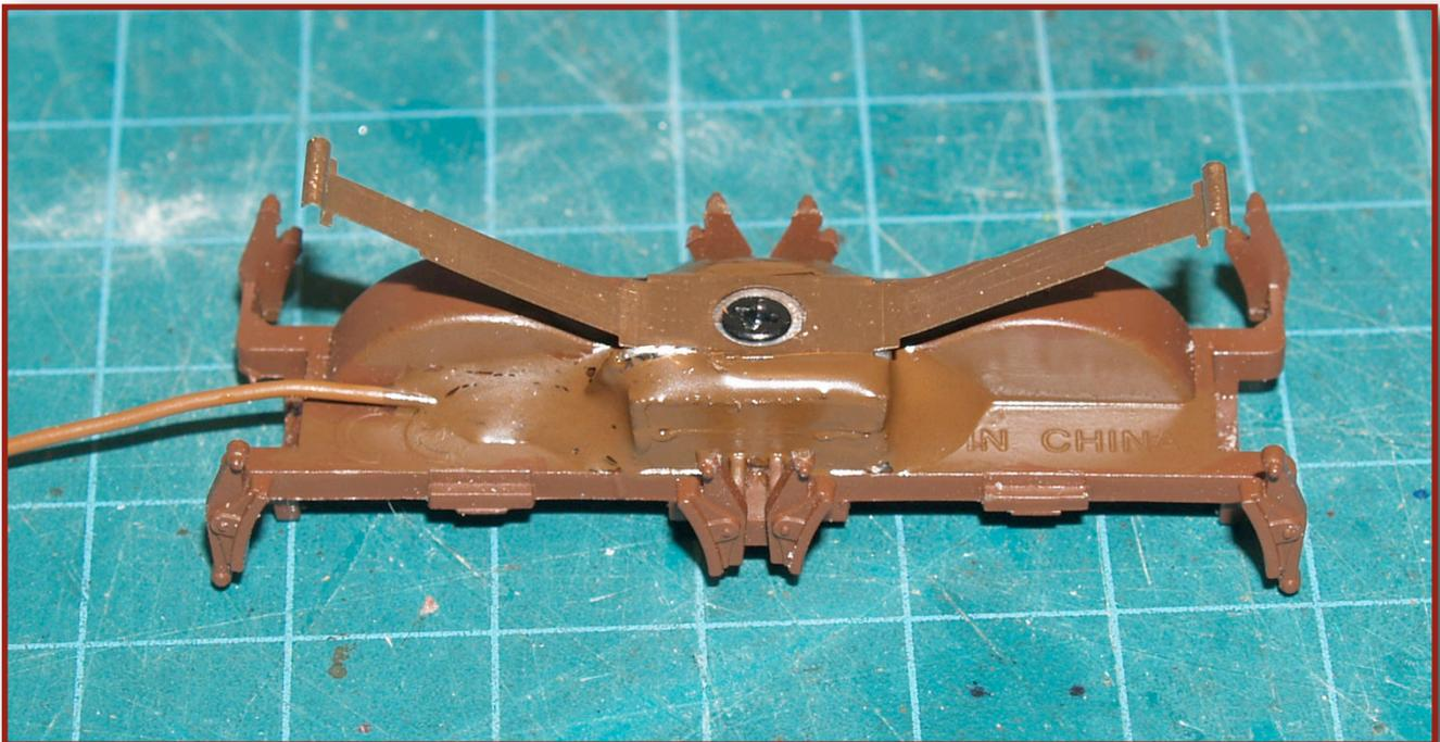
Internamente alla loco non ci sono problemi: dissaldare i fili provenienti dalle ruote di destra collegandoli assieme a quelli di sinistra e saldare al loro posto il filo proveniente dal pattino. Inserire il decoder e richiudere il tutto.
