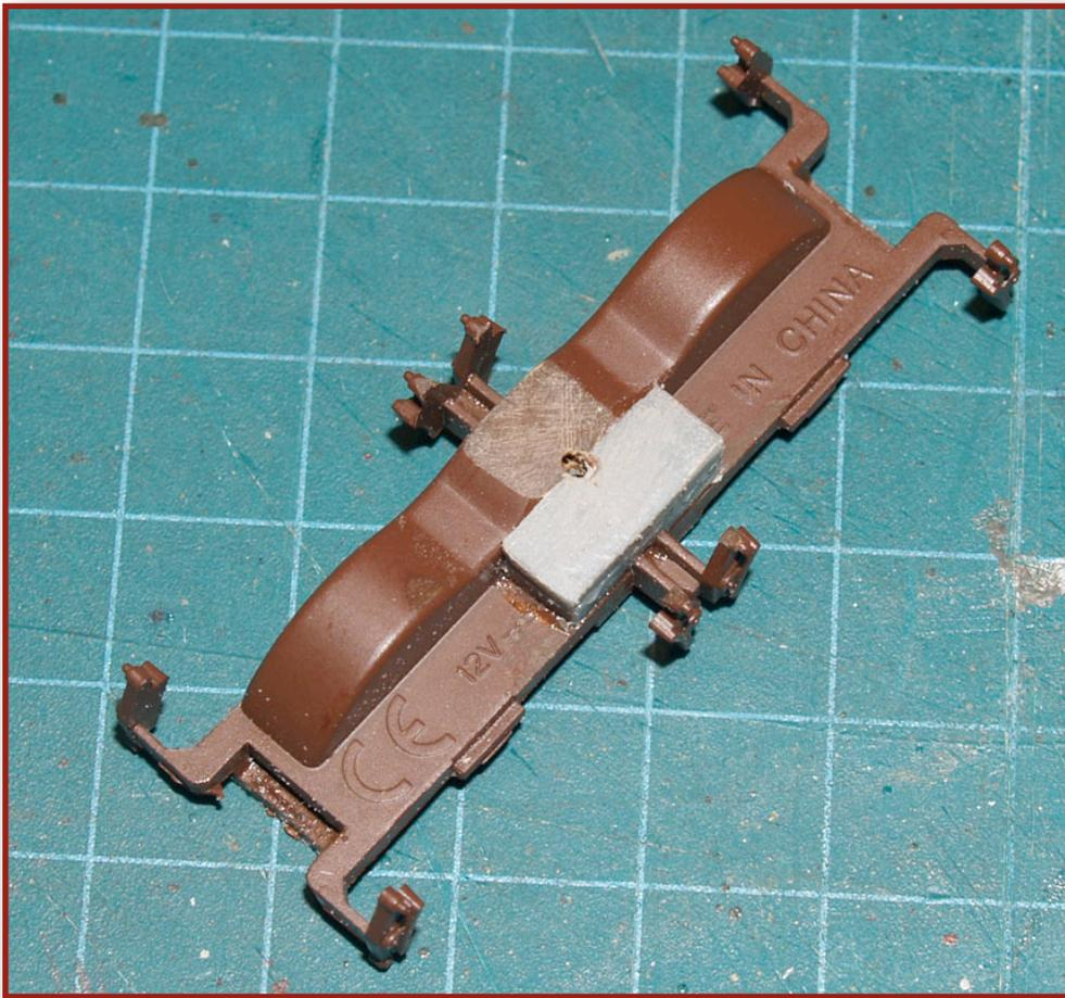
Avvitiamo il pattino, saldiamoci il filo dal lato verso il muso della loco e ultimiamo il fissaggio dell'insieme con un po' di colla epossidica (quella a due componenti).
