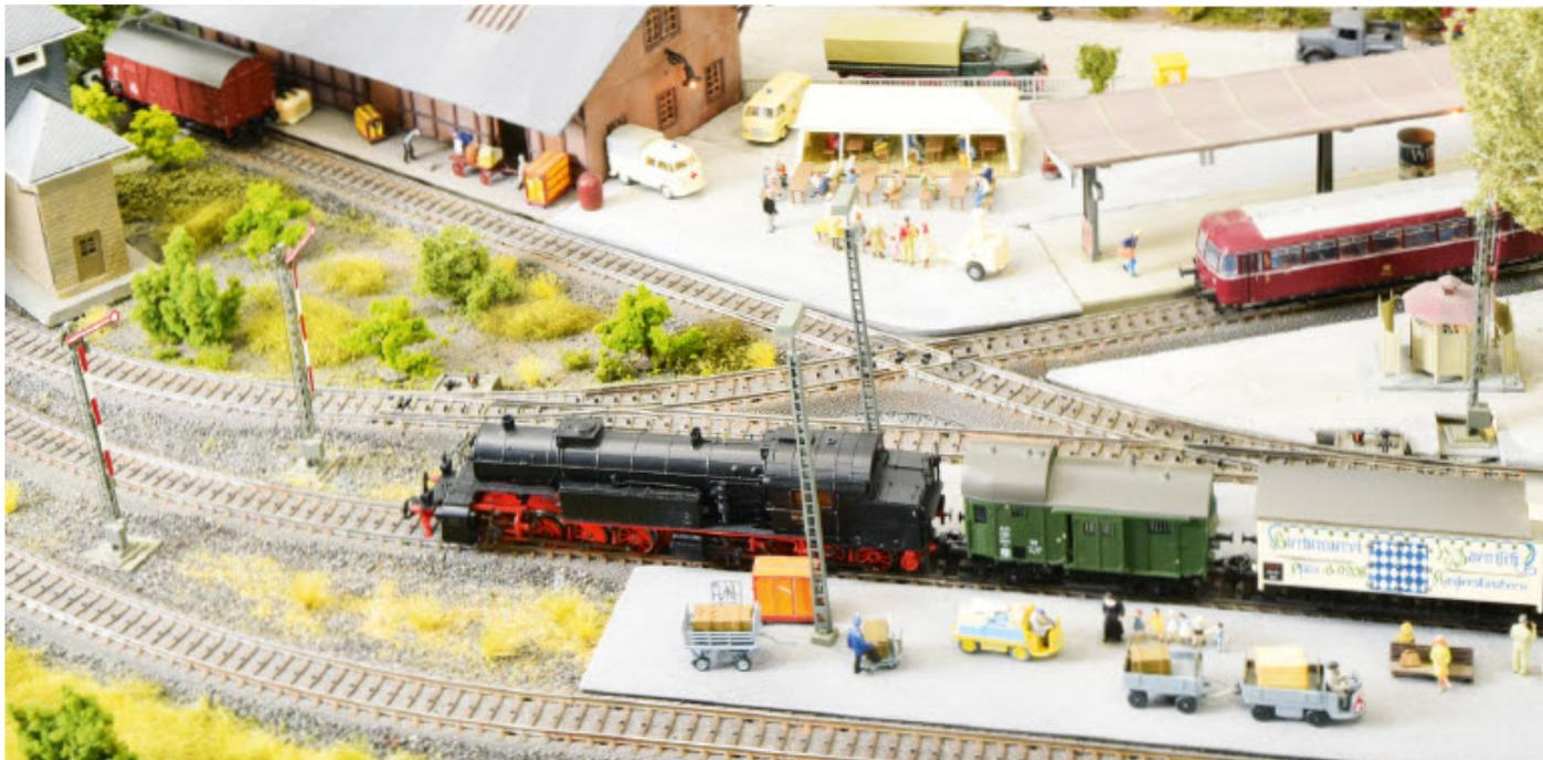
**Einfaches Prinzip bringt Sicherheit: Nur ein Zug pro Block! Jeder Streckenabschnitt wird mit einem Signal gesichert, sodass sich in jedem Block nur ein Zug befinden kann. Erst wenn der Zug eine Blockstrecke verlassen hat, wird diese für den nächsten Zug freigegeben.**
