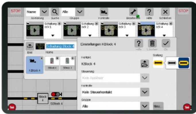
**Automatik einstellen: Der Auslösekontakt kann so konfiguriert werden, dass bei Belegt- oder Freilmeldung das Ereignis startet.**
