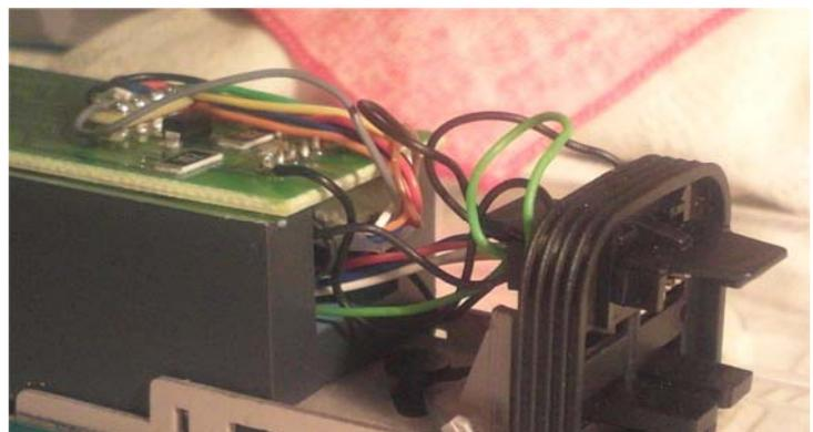
Una volta inserito ed alloggiato il decoder, la motrice può già essere provata sui binari. Prima di richiudere la carrozzeria, è fortemente consigliabile provare accuratamente il funzionamento in tutte le condizioni di criticità: scambi, curve strette, salite ecc. e anche con le rimorciate agganciate.
