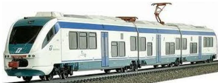
Il modello, come il prototipo, è costituito da tre elementi: alle estremità due motrici (Ale501 e Ale502) e un folle centrale (Le 220) che porta i pantografi. Io ho eseguito la trasformazione della versione pantografata, ma è chiaro che le differenze con la versione diesel sono minime (nel modello intendo). A proposito dei pantografi, sono molto belli e realistici, con la conseguenza che lo strisciante è stretto: senza
