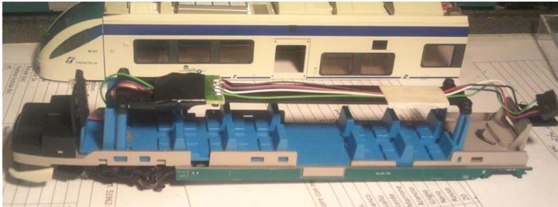
Quella basetta stampata fissata con del nastro isolante sulla canalina, è lì per ospitare un ulteriore connettore che porta i fili ai fari e alle prese sul carrello.
